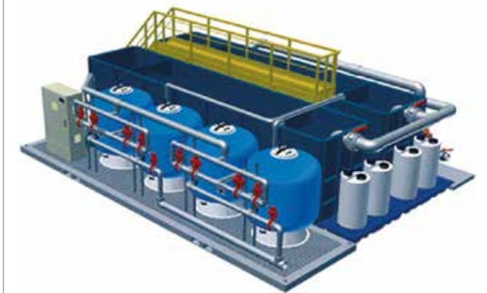
Figura No 3. Esquema tecnología de Planta Compacta
