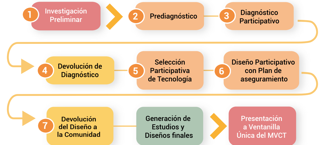
Figura No. 1. Flujograma de las etapas de la Planificación Participativa para establecer sistemas de potabilización de agua y optimizar el saneamiento en sitio
